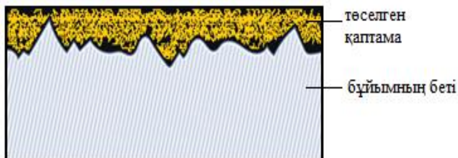
Сурет 3.20 - Диэлектрлік бетінде фотохимиялық жолмен алынған мыс қабықшасының құрылымдық бейнесі.
