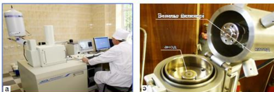
а) микроскоптың жалпы көрінісі; ә) электронды зеңбірек (оқ)
